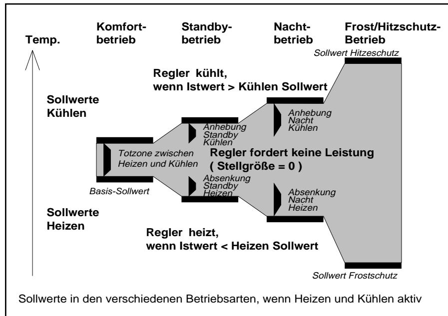
Bei stetigem Regelverhalten und bei schaltendem PWM-Regler können die voreingestellten Regelparameter über den Anlagentyp der Heizungs- bzw. Klimaanlage verwendet werden. Sind andere Regelparameter notwendig, so können diese über die freie Parametrierung individuell eingestellt werden. Die freie Parametrierung sollte nur benutzt werden, wenn ausreichende Erfahrung in der Regelungstechnik vorliegt.
