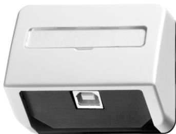
Das Anwendungsmodul USB-Schnittstelle dient zur Ankopplung eines PC mithilfe einer USB-Datenleitung an den EIB. Die USB-Schnittstelle wird auf einen Busankoppler UP aufgesetzt. Sie kann innerhalb des Systems an einer beliebigen Stelle integriert werden.
