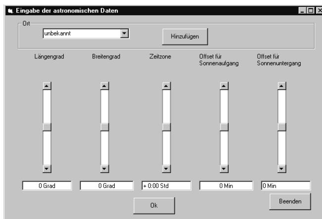
Die astronomische Schaltuhr berechnet aus den astronomischen Daten die Zeiten für Sonnenaufgang und Sonnenuntergang eines Jahres. Diese Zeiten sind Schaltzeiten der astronomischen Schaltuhr.
