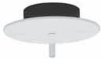
Mit dem Lichtfühler kann in geschlossenen Räumen die Helligkeit ermittelt werden. Die Installation des Lichtführers erfolgt in einer Standard-Installationsdose in der Decke. Die Abdækung (weiß) des Fühlers wird am Fühler festgeklebt. Die komplette Einheit wird in eine Unterputz-Dose verschraubt.
