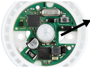
Abb. 6 Entfernen Sie die KNX-Klemme. Führen Sie das Buskabel durch die Kabel-Durchführung im Sockel und schließen Sie es an der Klemme an.
