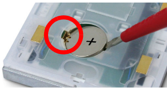
Abb. 7 Hebeln Sie ggf. die verbrauchte Batterie vorsichtig aus der Halterung. Achten Sie beim Einsetzen der neuen Batterie auf die Klipse und die Polung (+ muss sichtbar sein).
