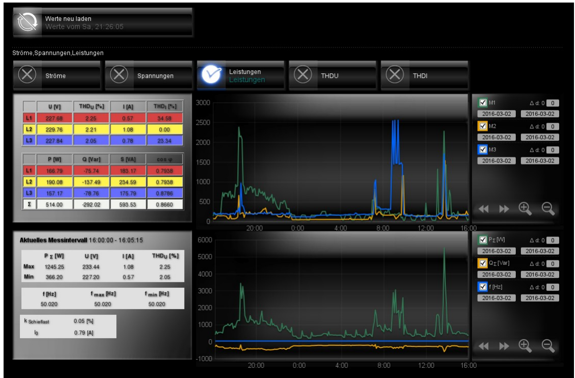
Abbildung 24: Visualisierung des aktuellen Verbrauchs im Enertex® EibPC
