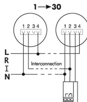
Anschluss 230 V ~ und Vernetzung + externes Schaltrelais (optional) zum Schalten von externen Geräten wie z. B. Sirenen, Blinkleuchten und Telefonwählgeräten.
