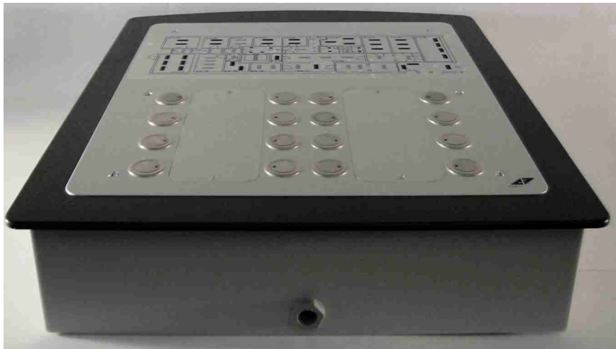
Abb. 1: EIB/KNX-Tableau (AP) mit Grundriss (Folie) und 16 Tastern / LED
