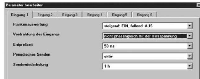
Dieser Parameter erscheint nur wenn bei „Verdrahtung des Eingangs“ „nicht Phasengleich mit der Hilfsspannung“ eingestellt wurde.
