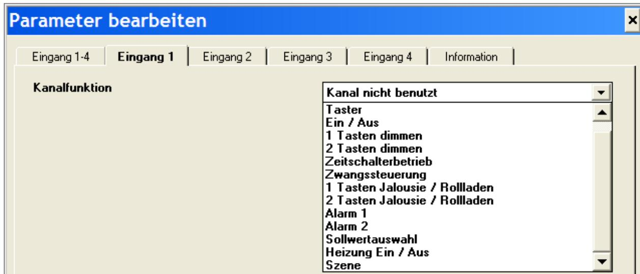
Für manche Funktionen erscheinen, nach Anwahl, im Parameterfenster zusätzliche Einstellmöglichkeiten (Zusatzparameter). An Hand der nachfolgenden Tabelle, erhalten Sie einen Gesamtüberblick der Kanalfunktionen, der funktionspezifischen Zusatzpara-
