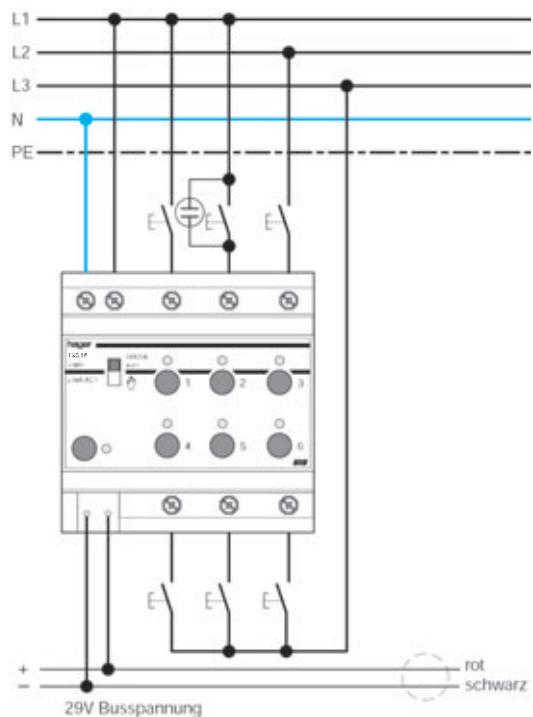
**Hinweis:** Die Eingänge können an verschiedenen Phasen geschlossen werden. Um die Funktion für das Erkennen eines Netzspannungsausfall nutzen zu können, muss die zu überwachende Phase an Klemme 3 angeschlossen werden.
