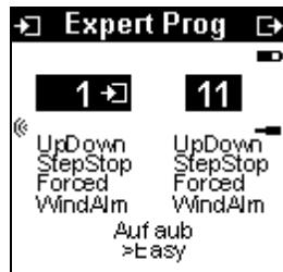
Mit dem Expertenmodus können Verbindungen zwischen Objekten mit dem selben Format durch Zuweisung der selben Gruppenadresse hergestellt werden.
