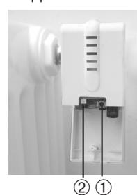
4. Schieben Sie das Gerät auf den Adaptrerring, bis er hörbar einrastet.
