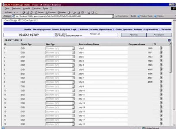
Diese Liste zeigt die laufende Nummer (0...79), den Datenpunkttyp gemäß ETS Parametrierung, den Wertebereich, den Namen und die mit der ETS zugewiesene Gruppenadresse. Die Namen der Objekte sind veränderbar, so dass eine sinnvolle Bezeichnung gewählt werden kann.
