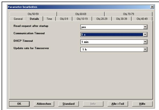
Soll die Echtzeituhr durch einen Zeit-Server justiert werden, sind zu diesem Zweck die Angaben der IP-Adresse des Zeit-Servers zu tätigen. Zusätzlich muss die Zeitzone, in der das Gerät eingesetzt wird, angegeben werden. Die Zykluszeit, wann die Zeitinformationen auf den EIB/KNX Bus gesendet werden, wird auch in dieser Maske eingestellt.
