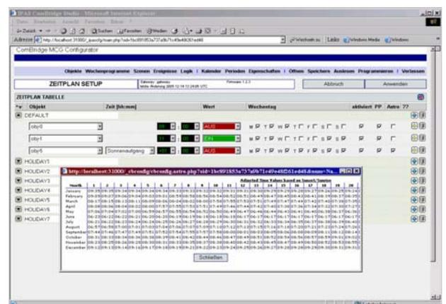
Je nach Standort werden die Sonnenaufgangszeiten (mit dem relativen Offset, in dem Beispiel 1 Stunde) angezeigt, um dem Anwender eine Vorstellung der tatsächlich berechneten Schaltzeitpunkte zu geben.
