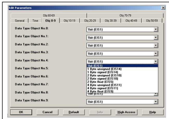
Nach dieser Definition wird das entsprechende Kommunikationsobjekt in der ETS angezeigt, um dort mit einer Gruppenadresse verbunden zu werden.
