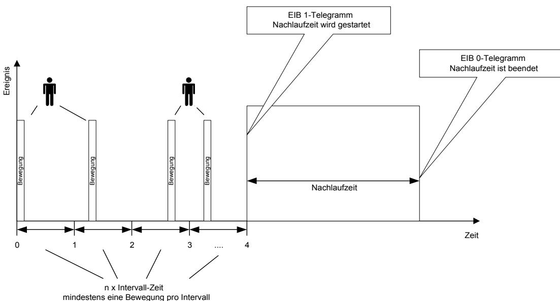
Auch in dieser Betriebsart kann parametrierbar werden, dass die Bewegungsdetektion nur aktiv ist, wenn die gemessene Beleuchtungsstärke unterhalb eines einstellbaren Schwellwertes liegt. Wie im Normalbetrieb lässt sich der Melder auch im HKL-Betrieb durch das Objekt 2 sperren (parametrierbar) und ggf. durch einen Slave-Melder extern Triggern (Objekt 3).
