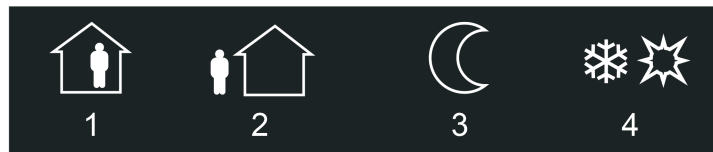
Bild 38: Statussymbole für die KNX Funktion "Betriebsmodusumschaltung 4 x 1 Bit"
