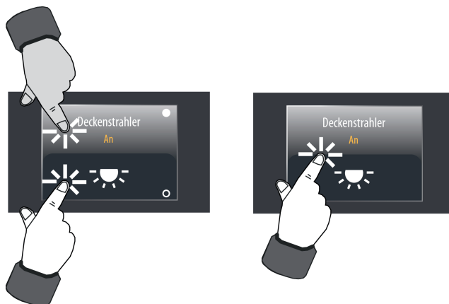
Bild 20: Beispiel zur Sensorauswertung bei Direktbedienung (KNX Funktion: Schalten) links: Wippe / rechts: Taste
