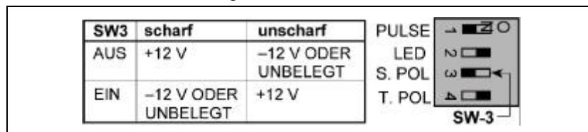
Vor Einstellen der Set-Polarität mittels des Schiebeschalters, sollte das Potential an der Alarmzentrale gemessen werden.
