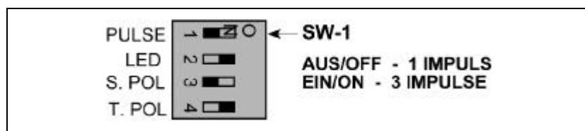
**AUS 1 -Impuls:** Diese Schalterstellung schaltet den Impulszähler ab. Diese Einstellung ist nur erforderlich, wenn besonders hohe Empfindlichkeit gewünscht wird.
