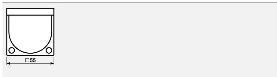
**IP** Mit Dichtungsset Art.-Nr.: AS A 50 DS und programmsspezifischen "IP-44-Rahmen" ist der Schutzgrad IP 44 gewährleistet.
