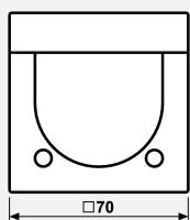
**IP** Mit Dichtungsset Art.-Nr.: AS CD 50 DS und programmspezifischen "IP-44-Rahmen" ist der Schutzgrad IP 44 gewährleistet.
