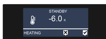
Bild 27: Absenkung der Solltemperatur Heizen (Menüebene 2)
