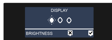
Bild 34: Einstellung der Displayhelligkeit (Menüebene 2)
