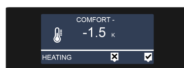
Bild 19: Absenkung der Solltemperatur Heizen (Menüebene 2)
