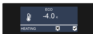
Bild 23: Absenkung der Solltemperatur Heizen (Menüebene 2)
