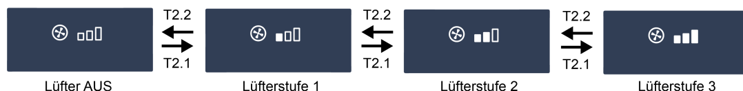
Bild 8: Einstellung der manuellen Lüftersteuerung (Bedienebene)
