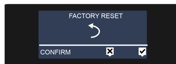
Bild 32: Rücksetzen auf Werkseinstellungen (Menüebene 2)
