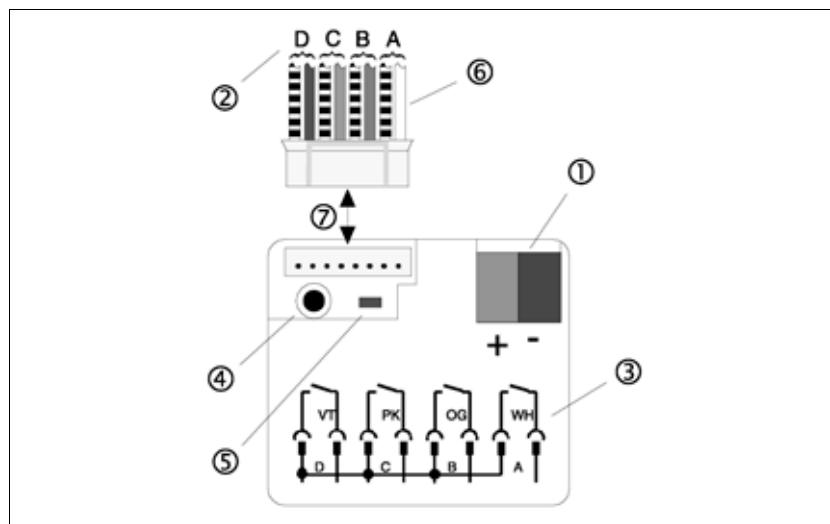
Der achtadrige Leitungssatz ⑥ darf um max. 5 m verlängert werden. Er wird auf die Tasterschnittstelle ⑦ gesteckt und dient zum Anschluss der Schalter/Taster.
