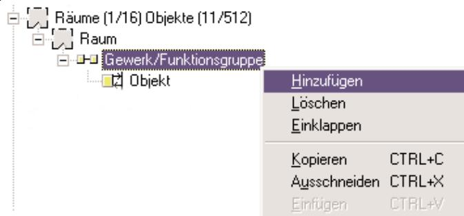
**Bild 29:** Anlegen eines Datenpunktes durch das Kontextmenü
