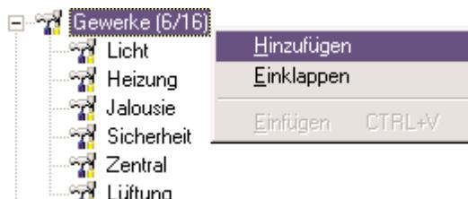
**Bild 23:** Anlegen eines Gewerkes durch das Kontextmenü
