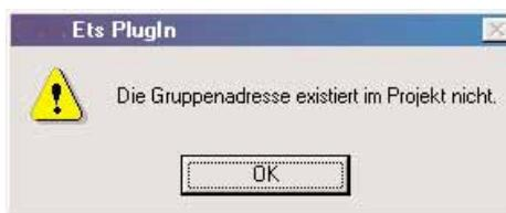
**Bild 41:** Fehlermeldung beim Versuch, eine nicht vorhandene Gruppenadresse zu verbinden
