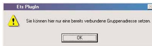
**Bild 38:** Fehlermeldung beim Versuch, eine nicht verwendete Adresse zu verbinden
