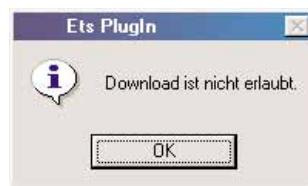
**Bild 1:** Hinweismeldung beim Versuch Applikationsdaten durch die ETS zu programmieren
