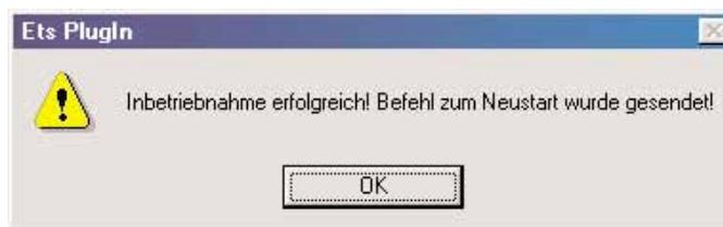
**Bild 12:** Bestätigung bei automatischem Neustart nach abgeschlossenem Programmierungsvorgang
