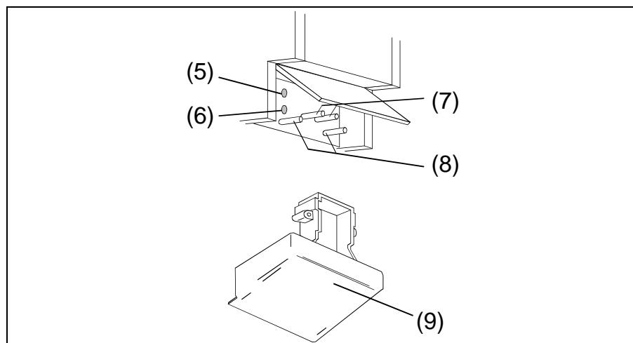
Busleitung nach unten aus dem Gerät herausführen. Anschließend Abdeckkappe (9) auf die Führungsstifte (8) aufsetzen und über die Busklemme schieben, um den Sicherheitsabstand zwischen Busleitung und 230-V-Leitungen zu gewährleisten. Die serielle Schnittstelle des PC (RS 232) wird über eine Datenleitung (1:1) mit der 9-poligen Sub-D Buchse (2) verbunden.
