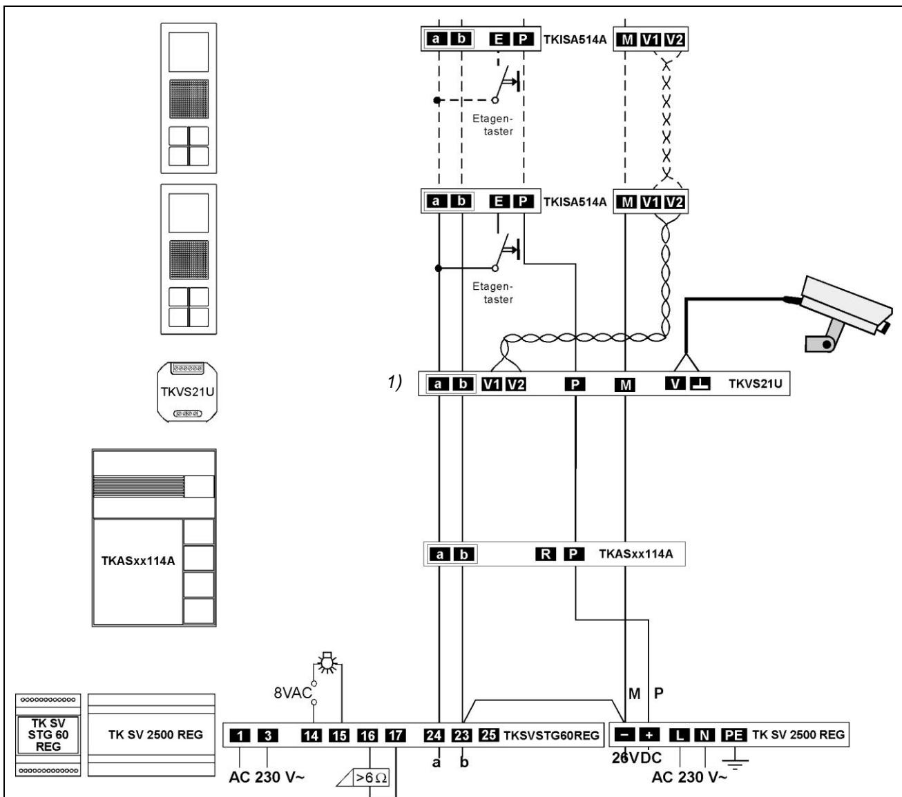
1) TCS:BUS-Klemmen a und b am TK VS 21 U sind nur Hilfsklemmen ohne Funktion und müssen nicht angeschlossen werden, wenn M und P angeschlossen sind.
