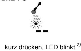
kurz drücken, LED blinkt <sup>2)</sup>Programmiertaste an BRE-Relais
