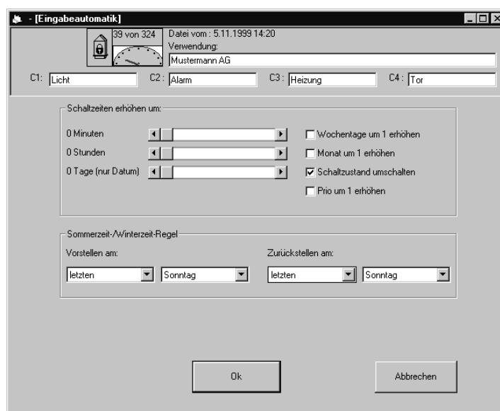
Das Werkzeug erleichtert und beschleunigt die Programmierung von Ein-/Aus-, Datums- und Prioritätsschaltzeiten, die in bestimmten Regelmäßigkeiten erfolgen sollen.
