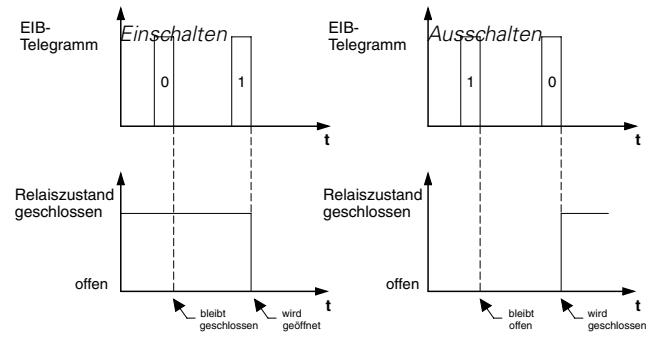
Nach Busspannungswiederkehr wird bei der Funktion „Öffner“ das Relais geschlossen und bei aktiver Rückmeldefunktion ein „1“ -Rückmeldetelegramm erzeugt, wenn kein anderes Einschaltverhalten (z.B. durch übergeordnete Funktion oder Verhalten bei Busspannungswiederkehr) den Ausgang in eine geöffnete Position schaltet.
