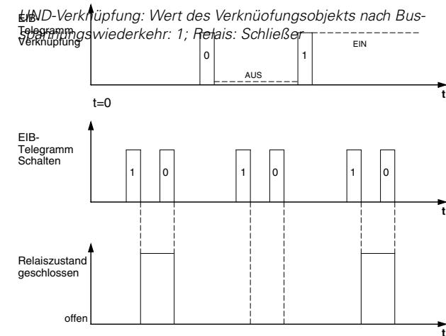
Das Verknüpfungsobjekt ist nach einem RESET mit einer „1“ vorbelegt. Somit kann über das Schaltobjekt wie gewohnt geschaltet werden. Erst nach Empfang eines „0-Telegramms über das Verknüpfungsobjekt ist die Einschaltverriegelung aktiv.
