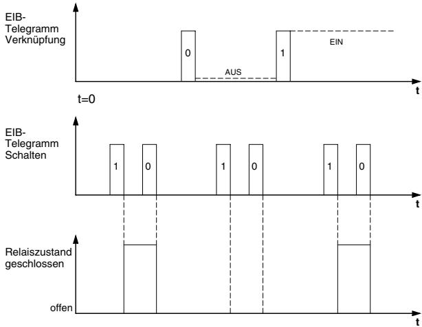
Das Verknüpfungsobjekt ist nach einem RESET mit einer „1“ vorbelegt. Somit kann über das Schaltobjekt wie gewohnt geschaltet werden. Erst nach Empfang eines „0“-Telegramms über das Verknüpfungsobjekt ist die Einschaltverriegelung aktiv.
