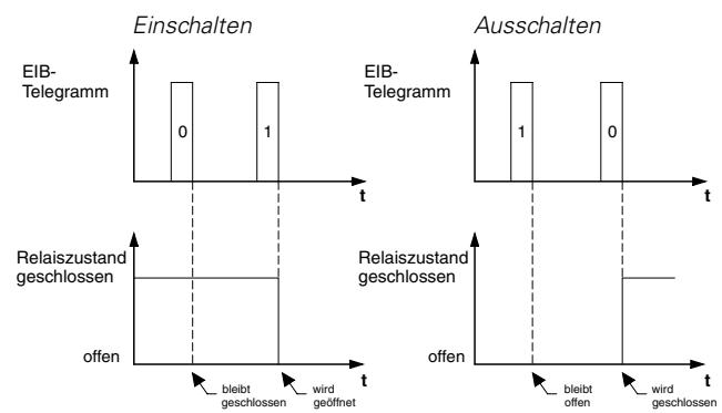
Nach Busspannungswiederkehr wird bei der Funktion „Öffner“ das Relais geschlossen und bei aktiver Rückmeldefunktion ein „1“ -Rückmeldetelegramm erzeugt, wenn kein anderes Einschaltverhalten (z.B. durch übergeordnete Funktion oder Verhalten bei Busspannungswiederkehr) den Ausgang in eine geöffnete Position schaltet.
