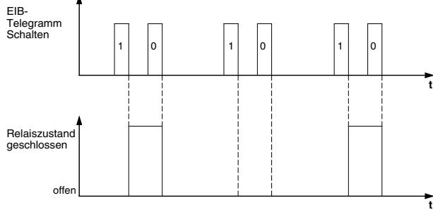
Das Verknüpfungsobjekt ist nach einem RESET mit einer „1“ vorbelegt. Somit kann über das Schaltobjekt wie gewohnt geschaltet werden. Erst nach Empfang eines „0“-Telegramms über das Verknüpfungsobjekt ist die Einschaltverriegelung aktiv.
