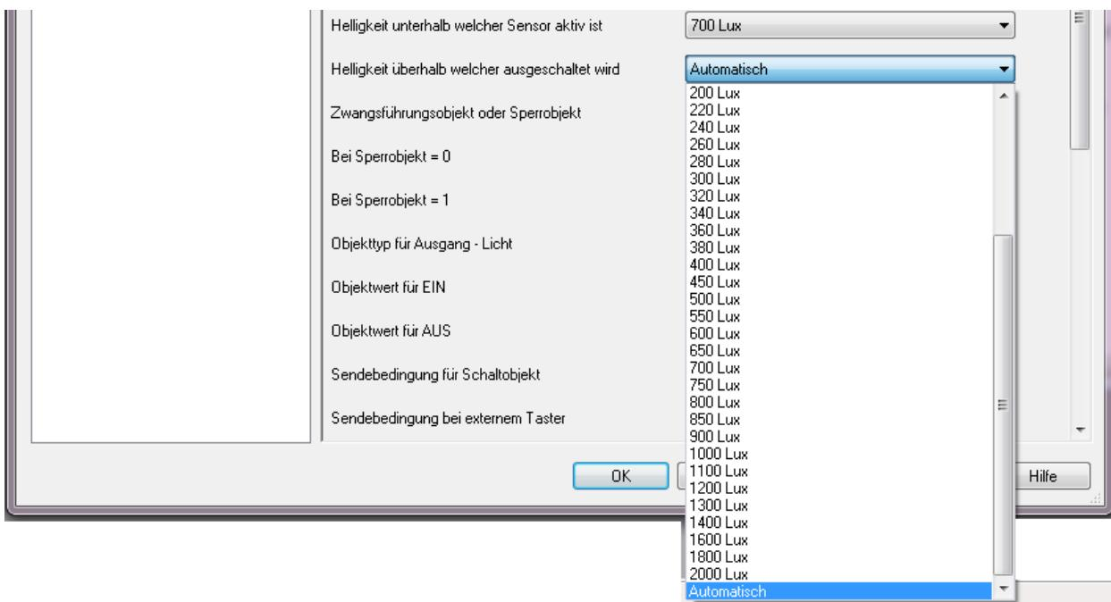
Die Licht- Aus- Schwelle wird jeweils nach abgelaufener Nachlaufzeit (Licht- AUS) und einer darauf erneuten Bewegungs- Detektion oder eines EIN - Schaltbefehls wieder neu berechnet.
