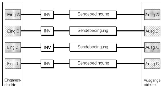
Über einen Sendefilter wird bestimmt, ob nur eine logische „0“, eine logische „1“ oder beide Ausgangswerte gesendet werden.
