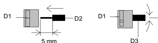
Bild 4: Anschließen / Abklemmen der Busleitungen
