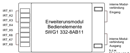
Bild 19: Steckerpositionen der Kanäle am Erweiterungsmodul Bedienelemente
