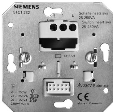
Der Schalteinsatz sys 5TC1 232 ist ein Unterputzgerät zum Schalten von verschiedenen elektrischen Verbrauchern. Es können Glühlampen, Hochvolt-Halogenlampen und Niedervolt-Halogenlampen mit vorgeschalteten konventionellen oder elektronischen Transformatoren angesteuert werden.
