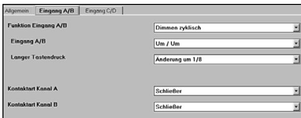
Die Parameter der beiden Eingangspaare A/B und C/D sind in der Funktion „Dimmen zyklisch“ identisch.
