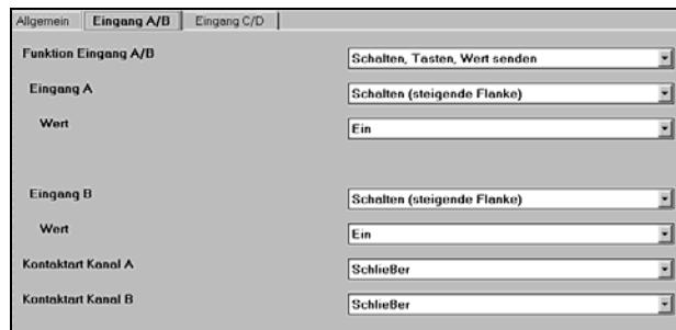
Die Parameter der beiden Eingangspaare A/B und C/D sind in der Funktion „Schalten (steigende Flanke)“ identisch.
