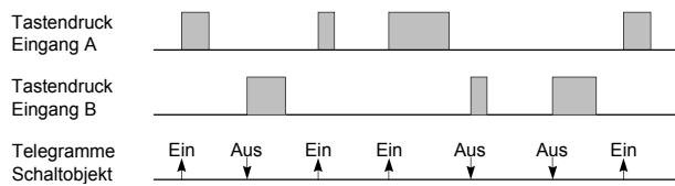
Funktion: Schalten (kurzer/langer Tastendruck)
