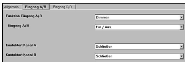
Die Parameter der beiden Eingangspaare A/B und C/D sind in der Funktion „Dimmen (mit Stoptelegramm)“ identisch.
