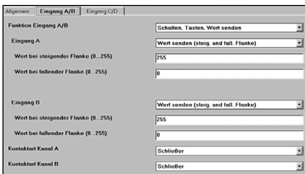
Die Parameter der beiden Eingangspaare A/B und C/D sind in der Funktion „Wert senden (steigende und fallende Flanke)“ identisch.
