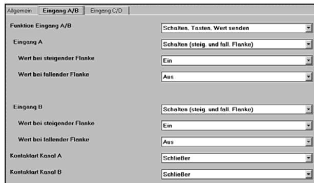
Die Parameter der beiden Eingangspaare A/B und C/D sind in der Funktion „Schalten (steig. und fall. Flanke)“ identisch.
