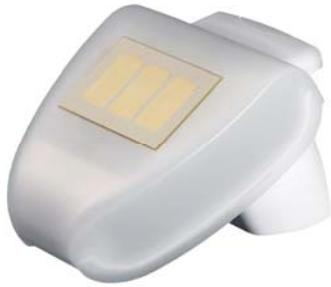
Die Wetterstation WS1 enthält in einem kompakten Gehäuse alle Sensoren, die Auswerte-Elektronik und die Bus-Ankopplung. Sie misst Windgeschwindigkeit, Helligkeit und Temperatur, erkennt Dämmerung und Niederschlag und empfängt das DCF77-Funksignal für Datum und Zeit. Neben Datum und Zeit können alle Messwerte im EIS5-Format auf den Bus gesendet und jeweils auf bis zu 3 Grenzwerte überwacht werden. Grenzwerte können als Parameter oder als Kommunikationsobjekte gewählt werden.
