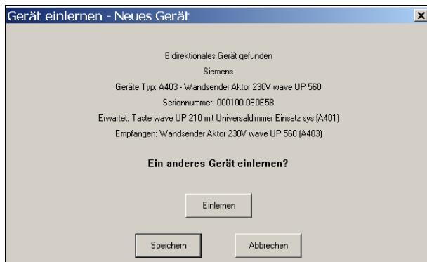
Im Fenster „Gerät einlernen“ erscheint ein Hinweis über die unterschiedlichen Gerätetypen (z. B. Projektiertes Gerät: Taste wave UP 210 mit Universaldimmer Einsatz sys. Eingelerntes Gerät: Wandsender Aktor 230V wave UP 560).
