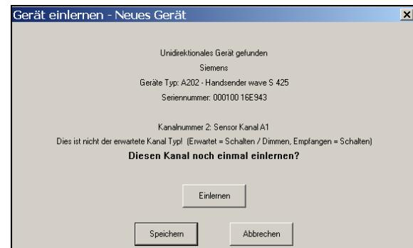
Im Fenster „Gerät einlernen“ erscheint ein Hinweis über die unterschiedlichen Kanaltypen (z. B. Projektierter Kanaltyp: Schalten/Dimmen. Eingelernter Kanaltyp: Schalten).
