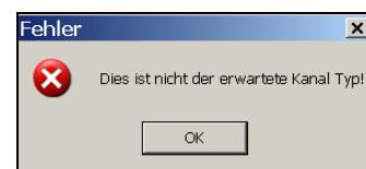
Bei einstellbaren Sensorkanälen ist darauf zu achten, dass die parametrierte Sensorfunktion (Schalten, Schalten/Dimmen, Jalousie, Szene) mit der beim Einlernen am wave-Gerät eingestellten Funktion übereinstimmt. Ist dies nicht der Fall, erscheint diese Fehlermeldung.
