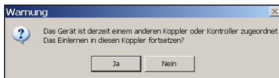
Bidirektionale Geräte können nur in einen Koppler oder Kontroller eingelernt werden, da dieser die Geräte über seine Domain Adresse (Seriennummer des Koplplers) anspricht. Diese Domain Adresse wird beim Einlernen in das bidirektionale Gerät geladen.
