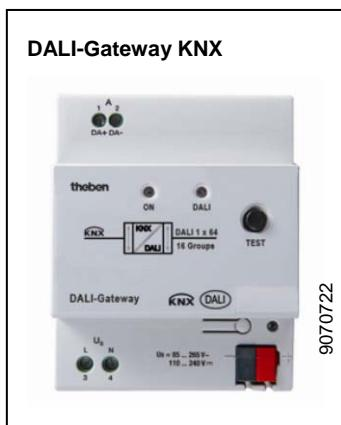
Das gruppenorientierte KNX-DALI-Gateway ist ein Reiheneinbaugerät. An einen DALI-Ausgang können bis zu 64 DALI-Teilnehmer angeschlossen und über 16 Leuchtengruppen angesteuert werden. Die DALI-Stromquelle für die 64 DALI-Teilnehmer ist im Gateway integriert.
