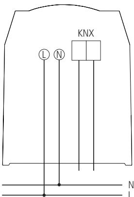
Betrieb ohne Netzspannung möglich. Die Heizung des Regensors und das GPS-Modul funktionieren dann nicht.
