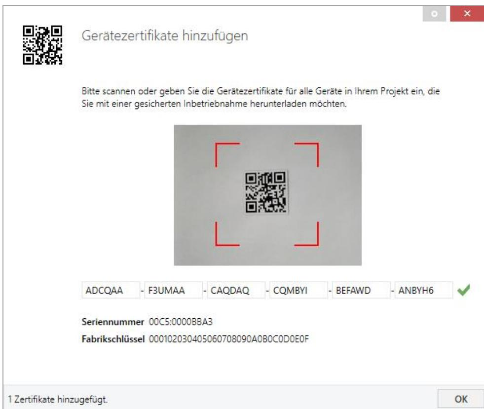
Das Zertifikat ist als Text auf dem Gerät aufgedruckt. Es kann auch über eine Webcam vom aufgedruckten QR-Code abgescannt werden.
