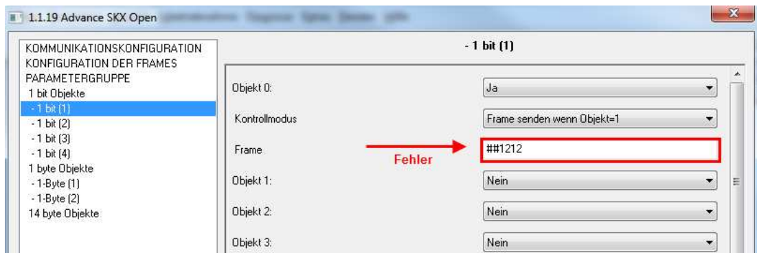
Bild 15. Frame mit einer fehlerhaften Benutzung des Spezialzeichens ##
