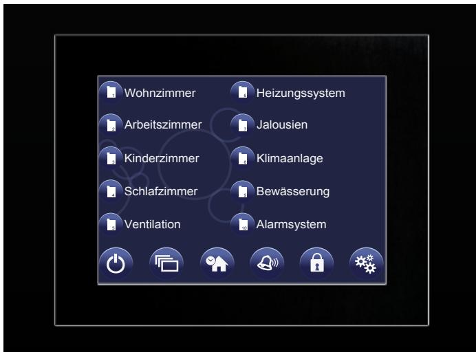
Das Bedienelement, das eine Stehlampe einschalten soll, enthält natürlich das Symbol einer Stehlampe. Der Programmierer des TouchControl ETS6C kann aus einer sehr umfangreichen Bibliothek die unterschiedlichsten Symbole einem Bedienelement zuordnen. Drucksensitive Flächen lassen die gewohnte Bedienung wie bei einem Wandtaster mit kurzem und langem Tastendruck zu.
