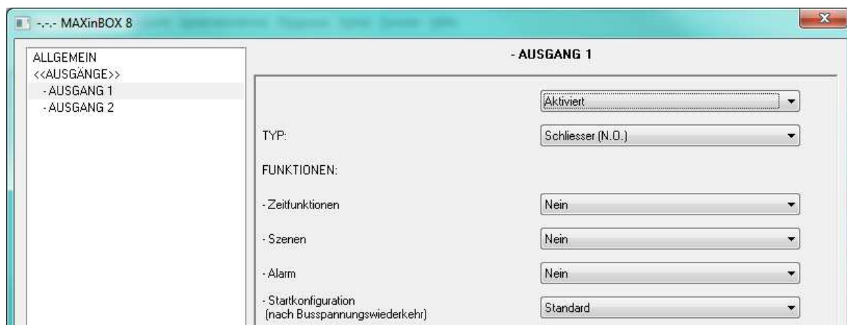
Bild 3.5 Kanal A, konfiguriert als individuelle Ausgänge.
