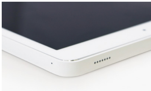
apertura para el micrófono y los altavoces
