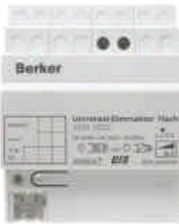
Der Universal-Dimmaktor 1fach kompakt arbeitet nach dem Phasenan- oder abschnittsprinzip und ermöglicht das Schalten und Dimmen von Glühlampen, HV-Halogenlampen sowie NV-Halogenlampen über konventionelle Trafos und Tronic-Trafos. Die Charakteristik der angeschlossenen Last wird automatisch eingemessen und das geeignete Dimmverfahren eingestellt.
