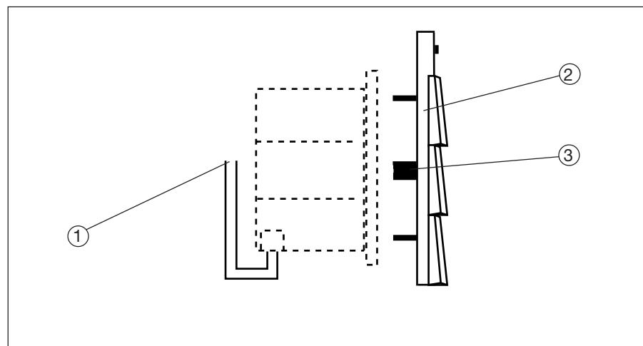
**1** Bus terminal**2** Application module**3** 10-pole plug**Note**
