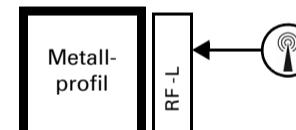
Das Antennen-Symbol auf dem Gehäuse zeigt die Position der Antenne im Gerät. Diese Seite darf nicht direkt an Metallflächen oder -gegenständen positioniert werden. Das Funksignal kann sonst gestört werden.
