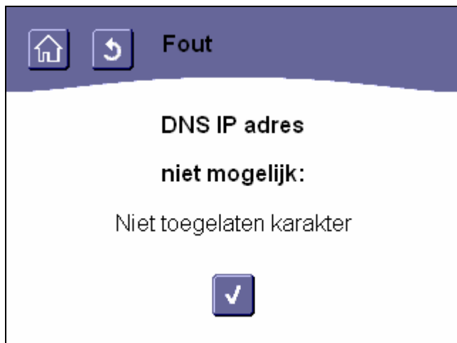
Figuur 226: Fout: ongeldig IP-adres voor DNS-server ingevoerd
