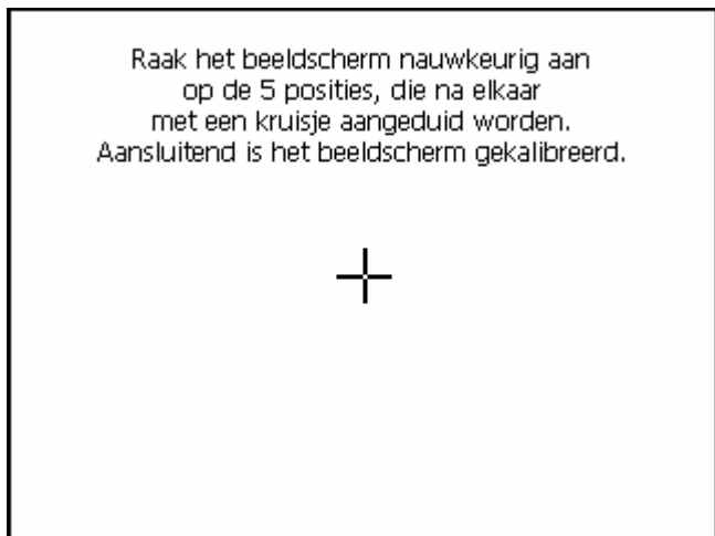
Figuur 27: Kalibratie van het aanraakgevoelige beeldscherm
