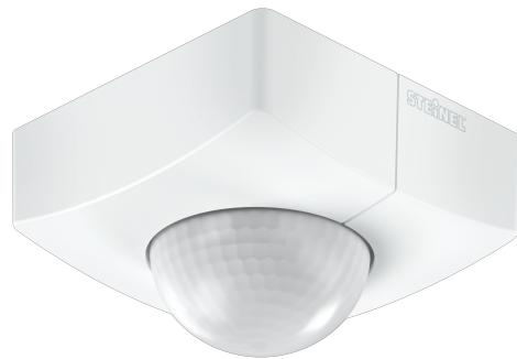
Schwindelfrei, Reichweitenstark. Zuverlässig. Bewegungsmelder IS 3360 MX Highbay – ideal für hohe Decken in Industriehallen oder Gewerbeimmobilien. Für Montagehöhen von bis zu 14 m. Hochpräziser 360°-Infrarot-Sensor. Maximale Reichweite: 18 m. Für eine Überwachung von bis zu 1000 qm. Erhältlich als eckige Aufputz- und Unterputz-Variante. DALI-2 Input Device erlaubt Sensoren, die erhobenen Sensordaten an übergeordnete Lichtmanagement-Systeme zu übermitteln.
