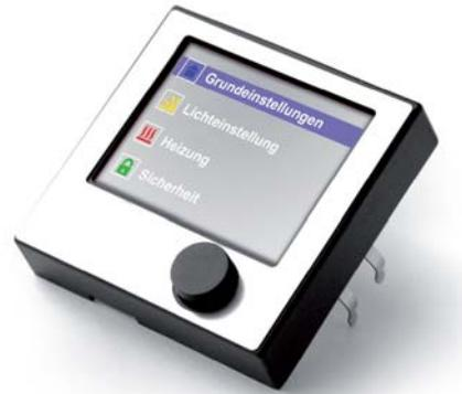
El MicroVis II logic posee un botón/ruedecilla, el display LCD a color con iluminación de fondo y un pequeño zumbador tipo piezo. Tanto la alimentación como la comunicación se realizan por completo a través del Bus KNX. Se puede combinar con los marcos estándar de 55mm de los diferentes fabricantes como, por ejemplo, Gira, Merten o Jung.
